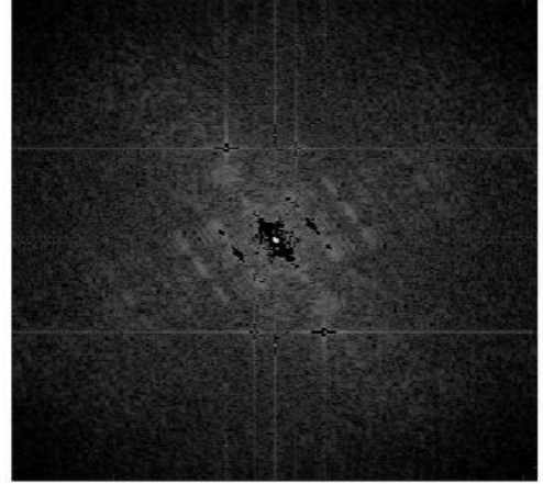
Şekil 2: Temizlenecek gürültülerin kapatılmış hali. En parlak "yıldız", DC bileşeni veya düşük değerleri kaldırmak istemediğimizden, resimlerin sıfırlandığı bir aralık oluşturduk. Böyle bir eşik aşağıda verilmiştir:
